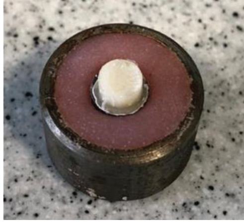
Resim 2. Akrilik rezin içine gömülen örnekler
