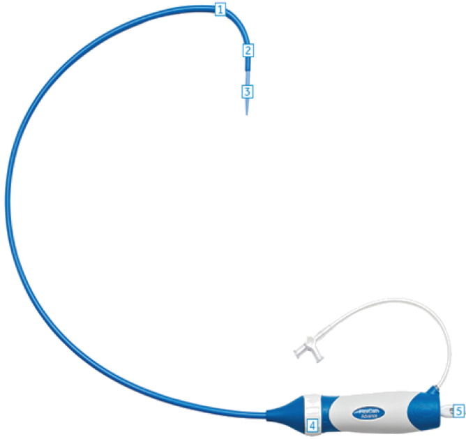
Resim 2. Kateter üzerindeki numaralandırmalara göre 1: Sheath dönüşü: 135 derecelik tek yönde dönme, 2. Radyoopak işareti: Floroskopi altında 5 mm görünürlük sağlayan işaret bandı, 3: Dilatatör: içerisindeki dilatatör, sheathin damar sistemine girişini kolaylaştırma, 4: Döndürme mekanizması: Maksimum döndürmeyi sağlamak için, ergonomik iki yöne çevirme sistemi, 5: Hemostaz valfi: Hava girişini önlemek, kanamayı azaltmak, kateterlerin ve kılavuz tellerin girişine, geri çekilmesine ve değiştirilmesine izin veren yapı
