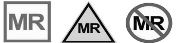
Şekil 2. IV. bölgeye alınacak taşınabilir nesnelere ilişkin ASTM International (American Society for Testing and Materials) tarafından geliştirilen FDA (Food and Drug Administration) paketleme kriterleri. Soldaki kare, MR güvenli olan tamamen non-metalik olan nesnelere için, ortadaki üçgen etiketi MR koşullu nesnelere için, sağdaki etiket ise MR güvenli olmayan nesnelere için geliştirilmiştir.
