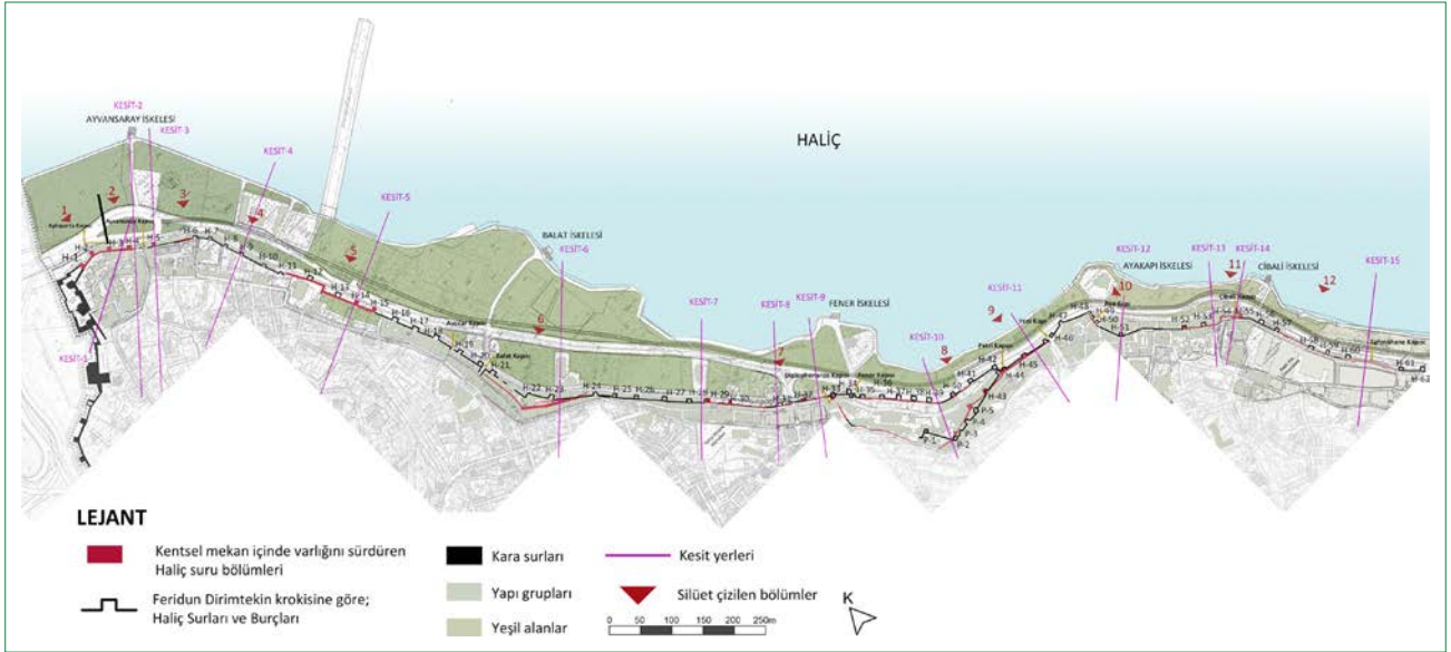
Şekil 8. Feridun Dirimtekin Krokisi (1956) ile Fatih Belediyesi Arşivinden Alınan 1/1000 ölçekli imar planının (04.04.2008) çakıştırılması ve 2018 yılında yapılan alan çalışmasına göre kapı, burç ve sur duvarları.
