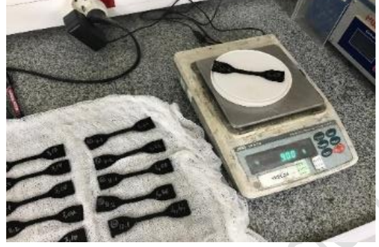
Şekil 6. Kimyasal çözeltilerde bekleyen numunelerin ağırlıklarının ölçülmesi
