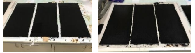
Şekil 2. Bitüm ve PU esaslı su yalıtım malzemeleri
