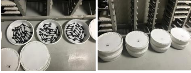
(a) Şekil 5. a) Numunelerin çözeltiye yerleştirilmesi b) Sıcaklık ve nem kontrollü laboratuvar ortamında bekletilmesi
