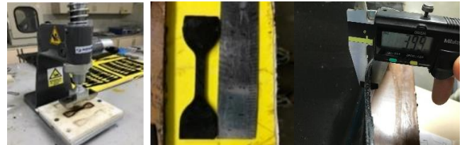
Şekil 3. a) Kesim cihazı b) Papyon yalıtım numunesi c) Kumpas ile yapılan boyut ölçümü
