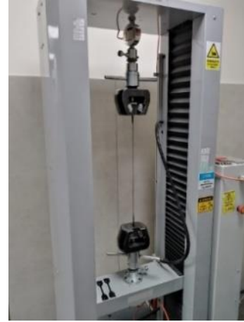
Şekil 7. Maksimum gerilme (çekme dayanımı) deneyi
