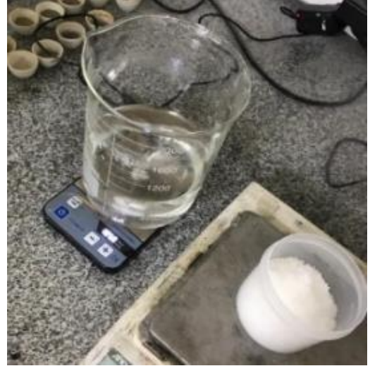
Şekil 4. MgSO_4 ve Na_2SO_4 çözeltilerinin hazırlanması
