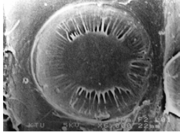
Şekil 2. Doğu ladini [ Picea orientalis (L.) Link.] odunu traheidlerinin radyal çeperlerinde bulunan aspirasyona uğramış bir kenarlı geçit çifti ( \times 6000 büyültmede) (Şahin, 1996)
