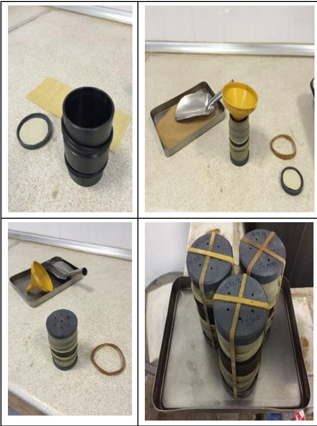
Şekil 2. Modifiye edilmiş çelik kalıplarda numune hazırlama.
