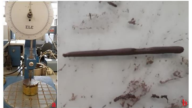
Şekil 6. a: Likit limitin deneyi, b: Plastik limit deneyi. Figure 6. a: Liquid limit test, b: Plastic limit test.
