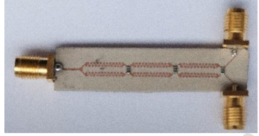
Şekil 12. İki yollu üç segmentli yapının imal devre fotoğrafı Figure 12. Photograph of three times cascaded two-way circuit
