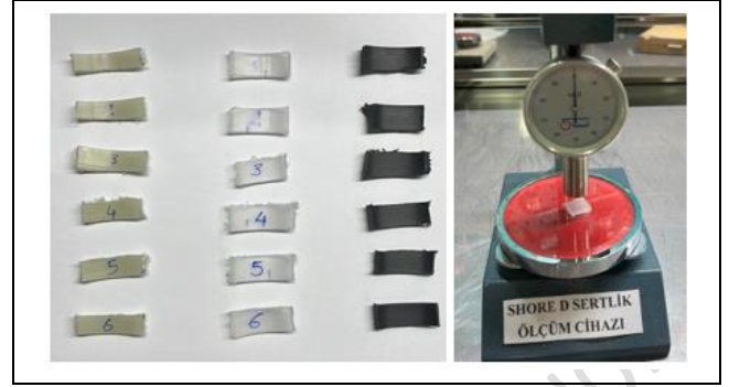
Şekil 6. Test numuneleri ve Shore D Sertlik ölçüm cihazı görselleri.
