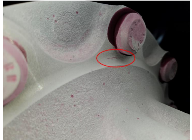
Şekil 9. Tasarım-A tekerlek poyrası üzerinde tespit edilen yorulma çatlak - 16 000 km.
