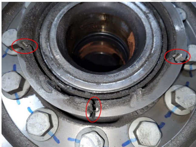
Şekil 12. Tasarım-B tekerlek poyrası üzerinde tespit edilen yorulma çatlakları.
