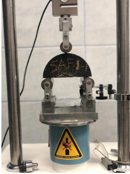
Şekil 4. SCB deneyi düzeneği Figure 4. SCB test setup
