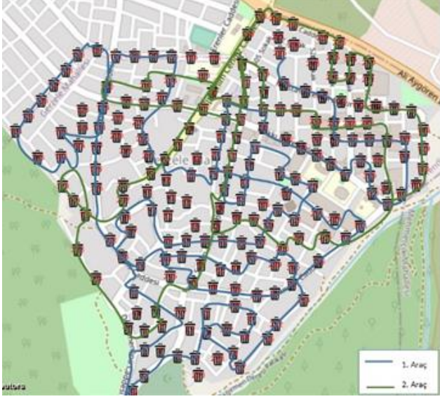
Şekil 12. Durum 4: %70 doluluk altındaki çöplerin rotaya katılmadığı 1. ve 2. araç rotaları.
