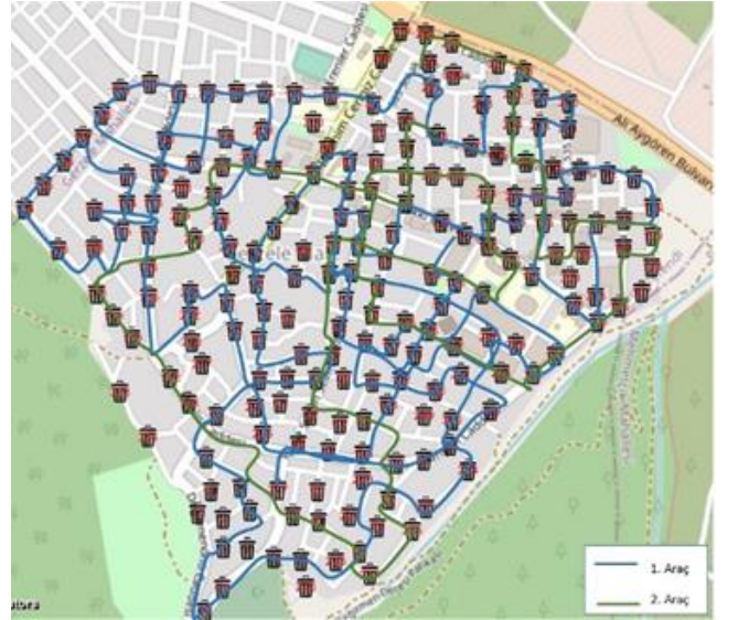
Şekil 11. Durum 3: %60 doluluk altındaki çöplerin rotaya katılmadığı 1. ve 2. araç rotaları.
