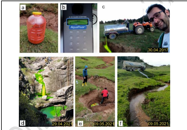
Şekil 6. (a) İzleme deneyinde kullanılan Na-floresan boya, (b) kaynak sularında izleyici konsantrasyonu ölçümünde kullanılan florometre cihazı (c) Susuzyayla bölgesinden, (d) Tınaztepe dolininden (e) Elmasut Eşekçukuru düdeninden yapılan izleyici enjeksiyonu ve (f) Elmasut Eşekçukuru düdeninde enjeksiyon sonrası yapay besleme.
