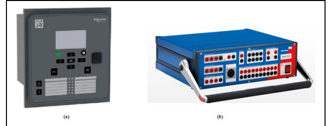
Şekil 5. Easergy P3U30 fider yönetim rölesi (a), Omicron CMC 356 röle test cihazı (b).
