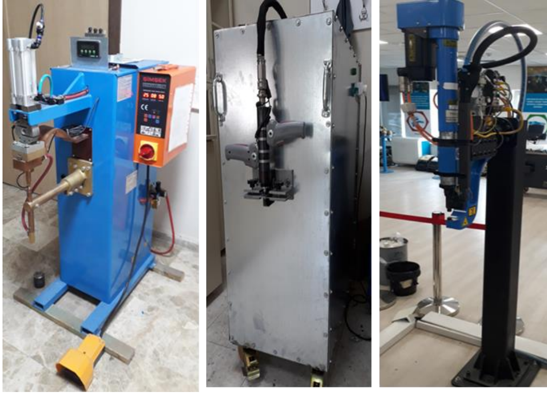
Şekil 3.2 Üç Farklı Sac Levha Bağlantı Tekniğe Ait Cihazlar a-EDK b-FP c-KDP
