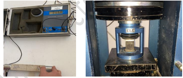
Şekil 4. Karo atıklı geopolimer harç numunelerinin ultrases geçiş hızlarının ölçülmesi ve basınç dayanımlarının belirlenmesi
