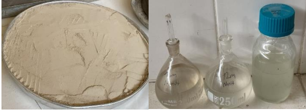
Şekil 1. Geopolimer harç yapımında kullanılan öğütülmüş, elenmiş etüv kurusu haline getirilmiş karo atığı ve 10M, 12M ve 14 M, 225 gr NaOH çözeltileri.
