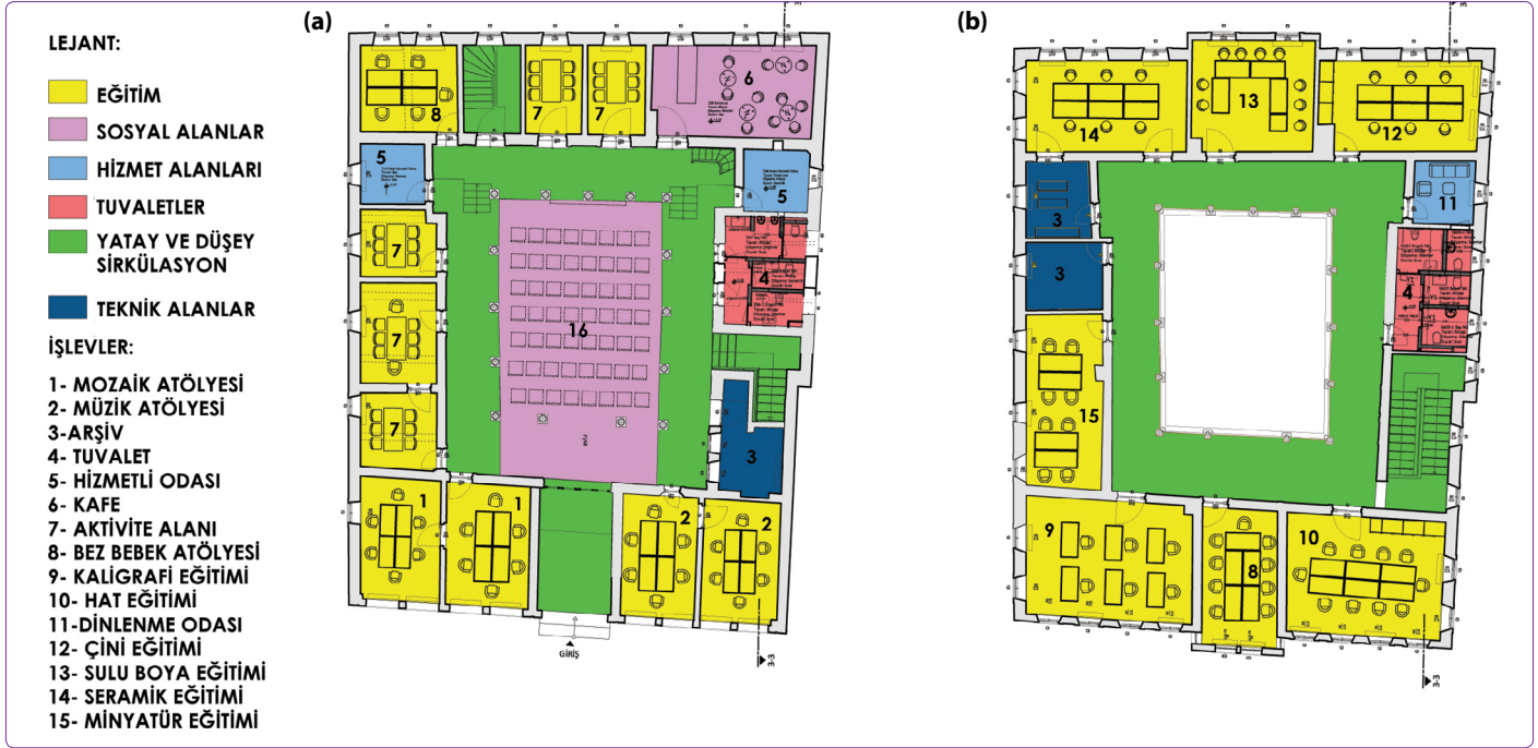
Şekil 25. (a) Zemin kat planı restorasyon-yeniden kullanım projesi işlev şeması; (b) Birinci kat planı restorasyon-yeniden kullanım projesi işlev şeması.
