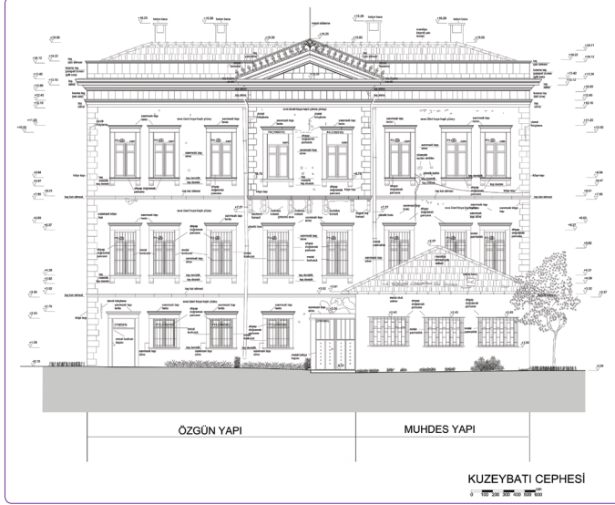
Şekil 17. Bahçe-deniz (batı) cephesi rölovesi.
