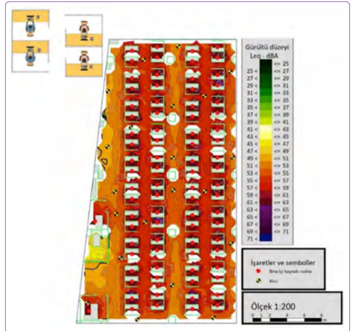
Şekil 11. Çağrı merkezi Model 5 gürültü düzey dağılımı gürültü haritası.
