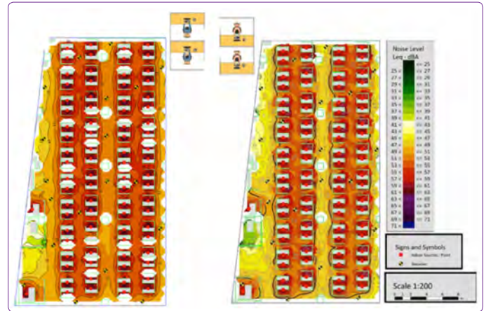
Şekil 12. Model 5-Toplam yutuculuğun artırılması (sol), Model 5-Toplam yutuculuğun ve engel etkinliğinin artırılması (sağ).
