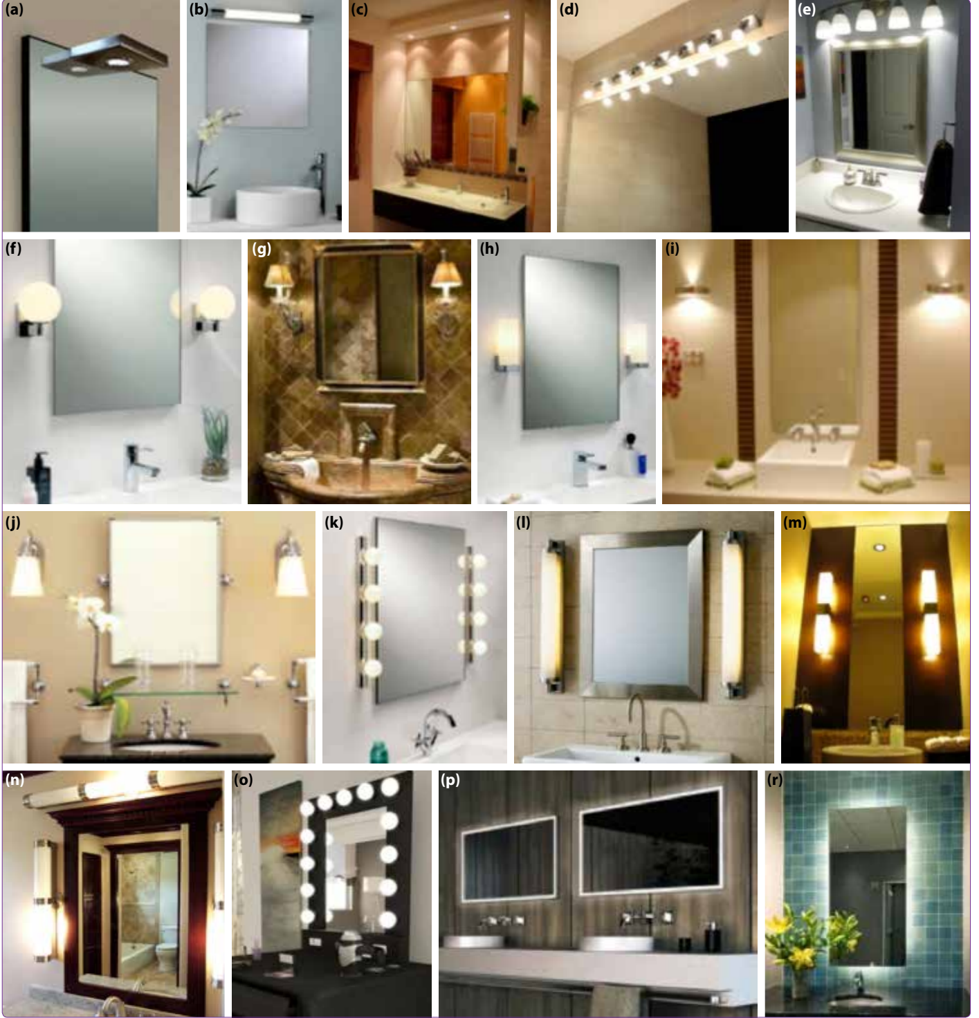
Şekil 1. (a-r) Ayna için yapılan bölgeik aydınlatmaya örnekler.
