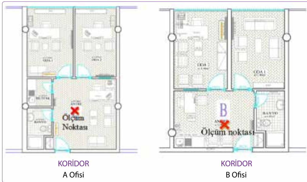
Şekil 6. Ofislere ait plan krokisi ve ölçüm noktaları.
