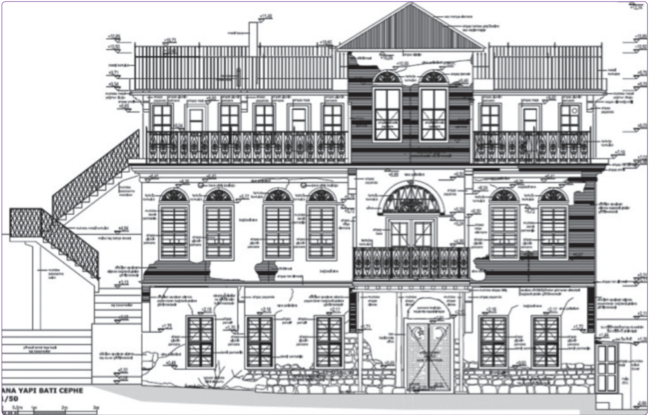
Şekil 25. Ana yapı batı cephe.
