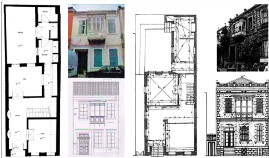
Şekil 9. Arka bahçeye uzanan servis birimlerinin olduğu 1 ve 2 No'lu plan tipleri ve cepheleri (Çıkış, 2009), (İ.İ.N.K.V.K.K, 2012).
