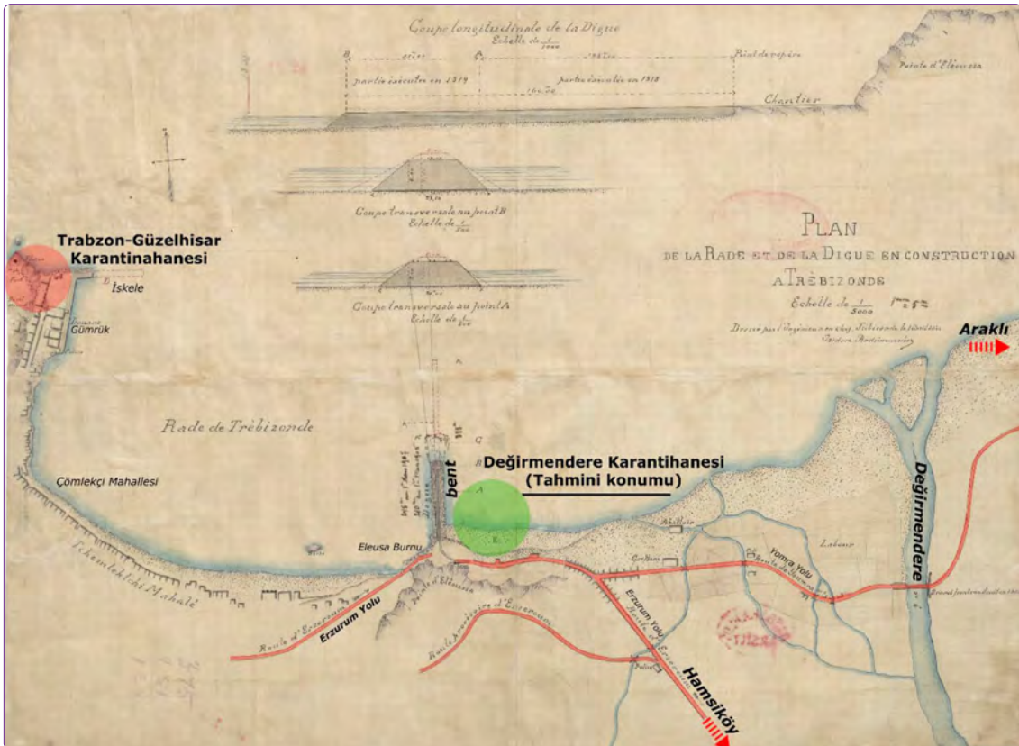
Şekil 9. Trabzon Limanı genişletme çalışmaları ve Değirmendere Bendi (HRT.h 629).
