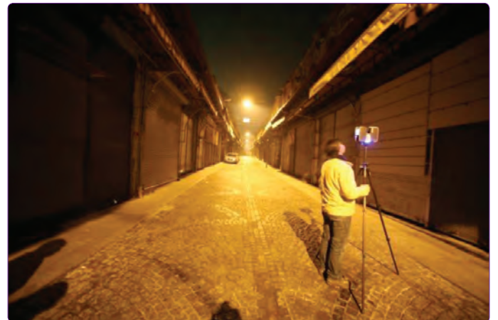
Şekil 7. Sarnıçlı Han dış cephesinde yersel lazer tarama cihazı ile yapılan gece taraması, 2012 (Kaynak: MDM Mimarlık Ltd.).
