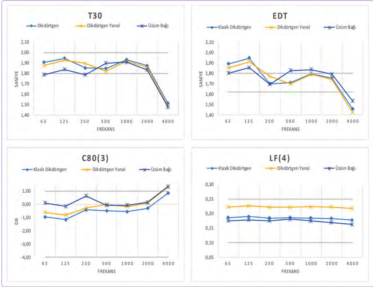
Şekil 6. T30, EDT, C80 ve LF parametrelerinin oktav bant hacim ortalama değerlerinin salon tipleri bazında karşılaştırması.
