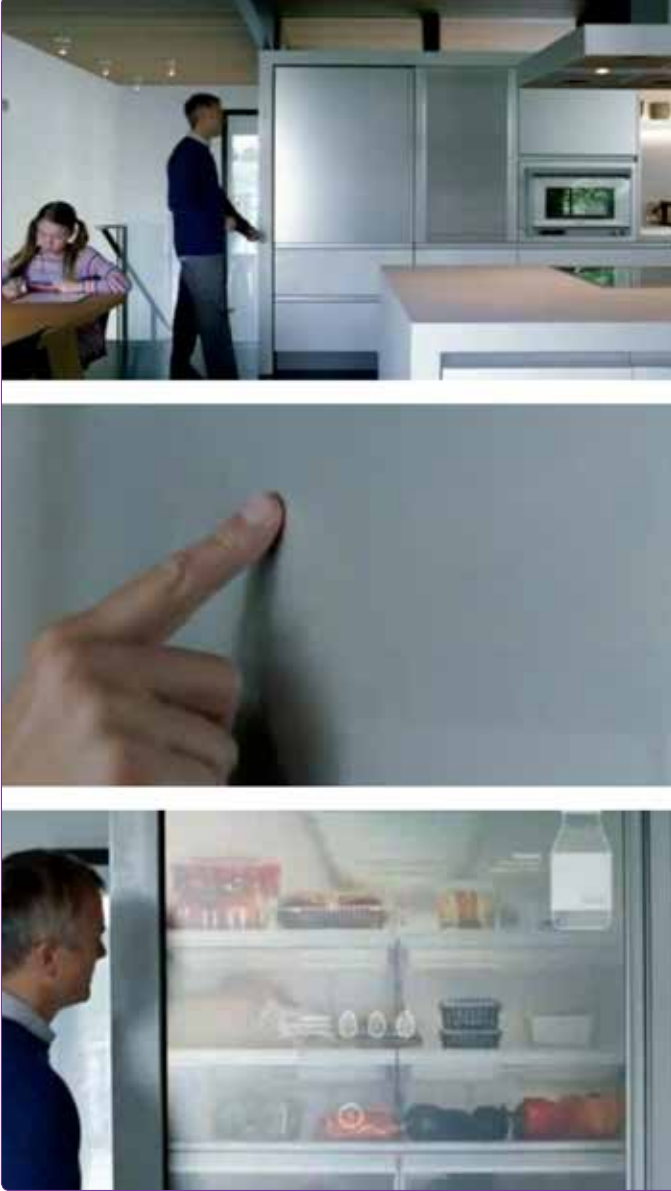
Şekil 2. Dokunmatik etkileşimli görsel geçirgenlik değişikliği gösteren yüzeye sahip, içindeki gıdaların miktarlarını algılayabilen bir buzdolabı. 12
