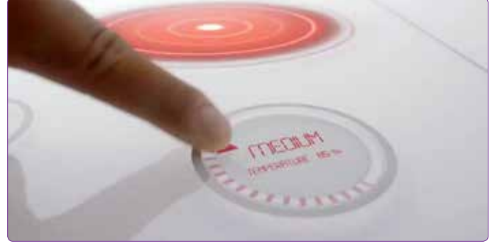
Şekil 3. Dokunmatik etkileşimli termal özellikli cam yüzeye sahip bir ocak tasarımı – Corning. 14
