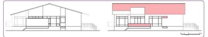
Şekil 9. B tipi konutun mimari projede yer alan cephesi ve uygulanmış cephesi (Aradaki farklar renklendirilmiştir). 11
