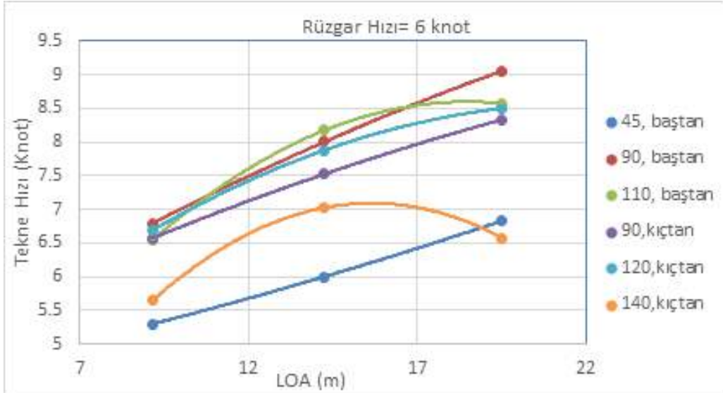
Şekil 2. Rüzgâr Hızı 6 knot İçin Gemi Boyuna Göre Tekne Hızının Değişimi
