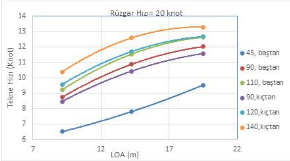
Şekil 4. Rüzgâr Hızı 20 knot İçin Gemi Boyuna Göre Tekne Hızının Değişimi
