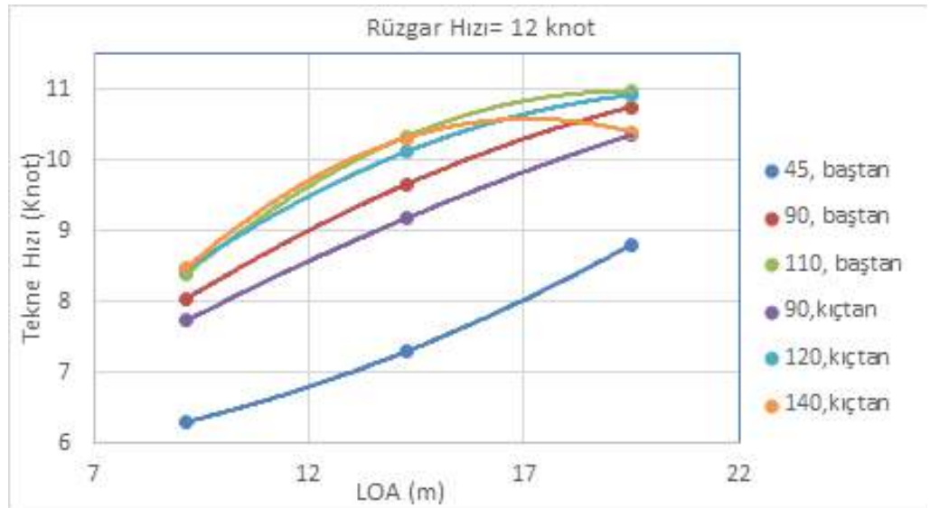
Şekil 3. Rüzgâr Hızı 12 knot İçin Gemi Boyuna Göre Tekne Hızının Değişimi
