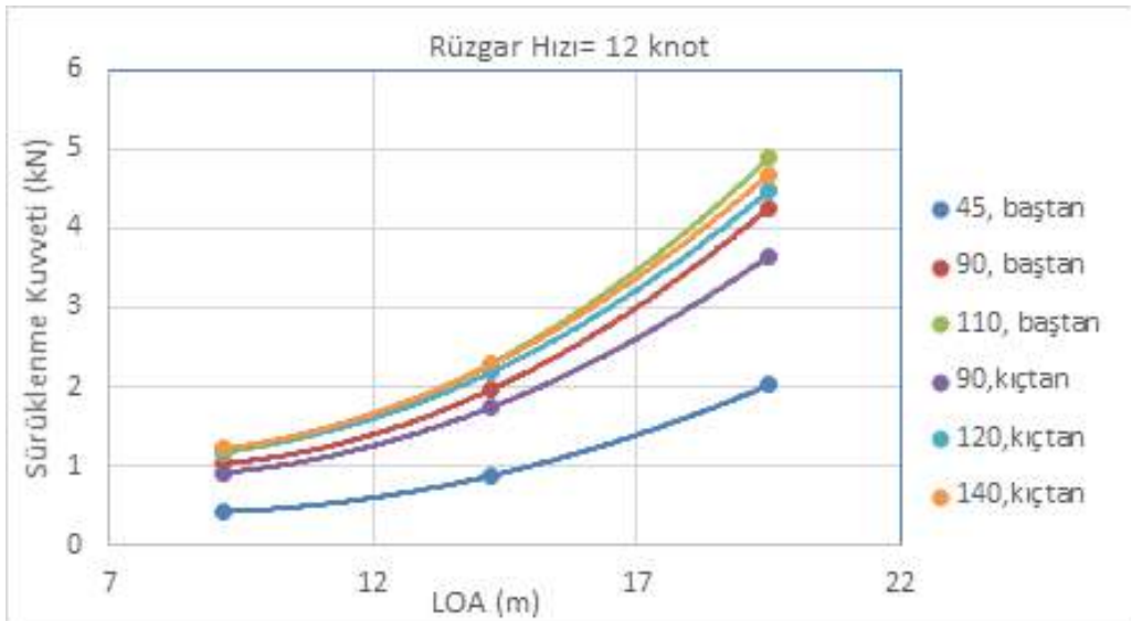
Şekil 6. Rüzgâr Hızı 12 knot İçin Gemi Boyuna Göre Sürüklenme Kuvvetlerinin Değişimi
