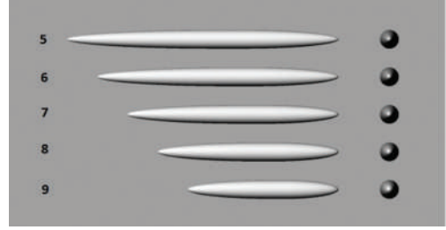
Şekil 3. İkinci Grup Denizaltı Gövde Modelleri
