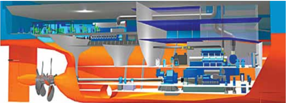
Şekil 5 Ters dönüşlü pervane çifti sistemi (8)
