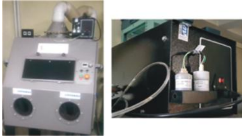
Şekil 1. Kaynak Duman Kabini (Sol) ve Gaz Analizörü (Sağ)
