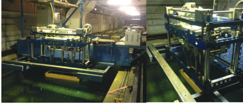
Şekil 5. Çekme Tankı ve Zorlayıcı Yalpa Deney Mekanizması
