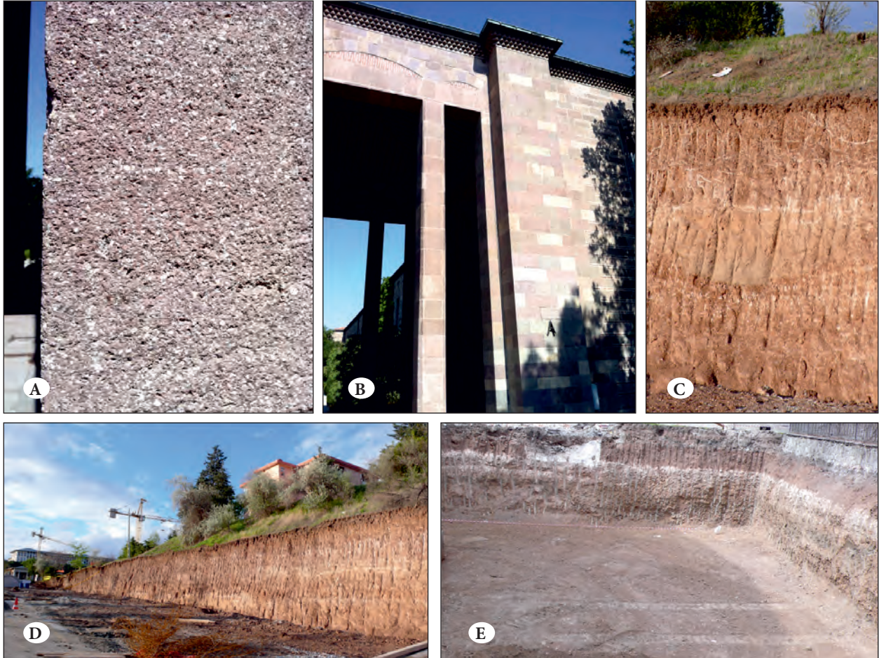
Şekil 7. A) Ankara taşının olağan dış görünüşü, B) Ankara taşı Fen Fakültesi binasında (A blok; parlayan ışıkta daha açık renkli görünür), C) Ankara kilinin tipik görünüşü. Atlı Spor Kulübü duvar inşaatı, D) Beştepe Külliye inşaatı kazısı, E) Ankara kili Maltepe inşaat temeli.
