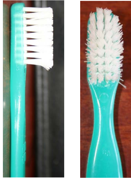
Resim 3. 3 ay kullanılmış ve çok yıpranmış bir fırçanın (a) yandan görünümü (b) üstten görünümü
