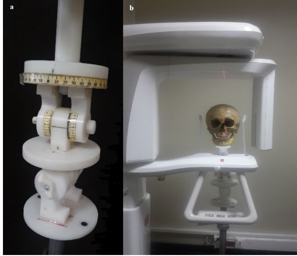
Şekil 1: a- Kurukafanın sabitlendiği her üç düzlemde açısal harekete izin veren ayaklı konumlandırıcı. b- Görüntülerin elde edildiği panoramik röntgen cihazı ve kurukafa modelin ideal pozisyonundaki resmi.
