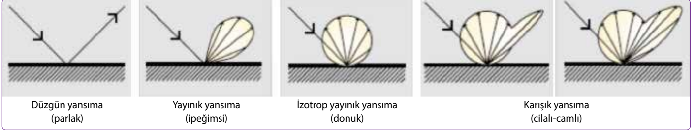
Şekil 3. Yüzeylerin doku özelliklerine göre ışığı yansıtma biçimleri.
