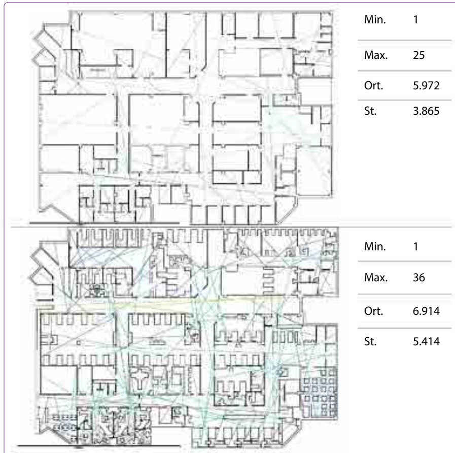
Şekil 5. K.E.A. Hastanesi donatılı ve donatısız axial connectivity analizi.
