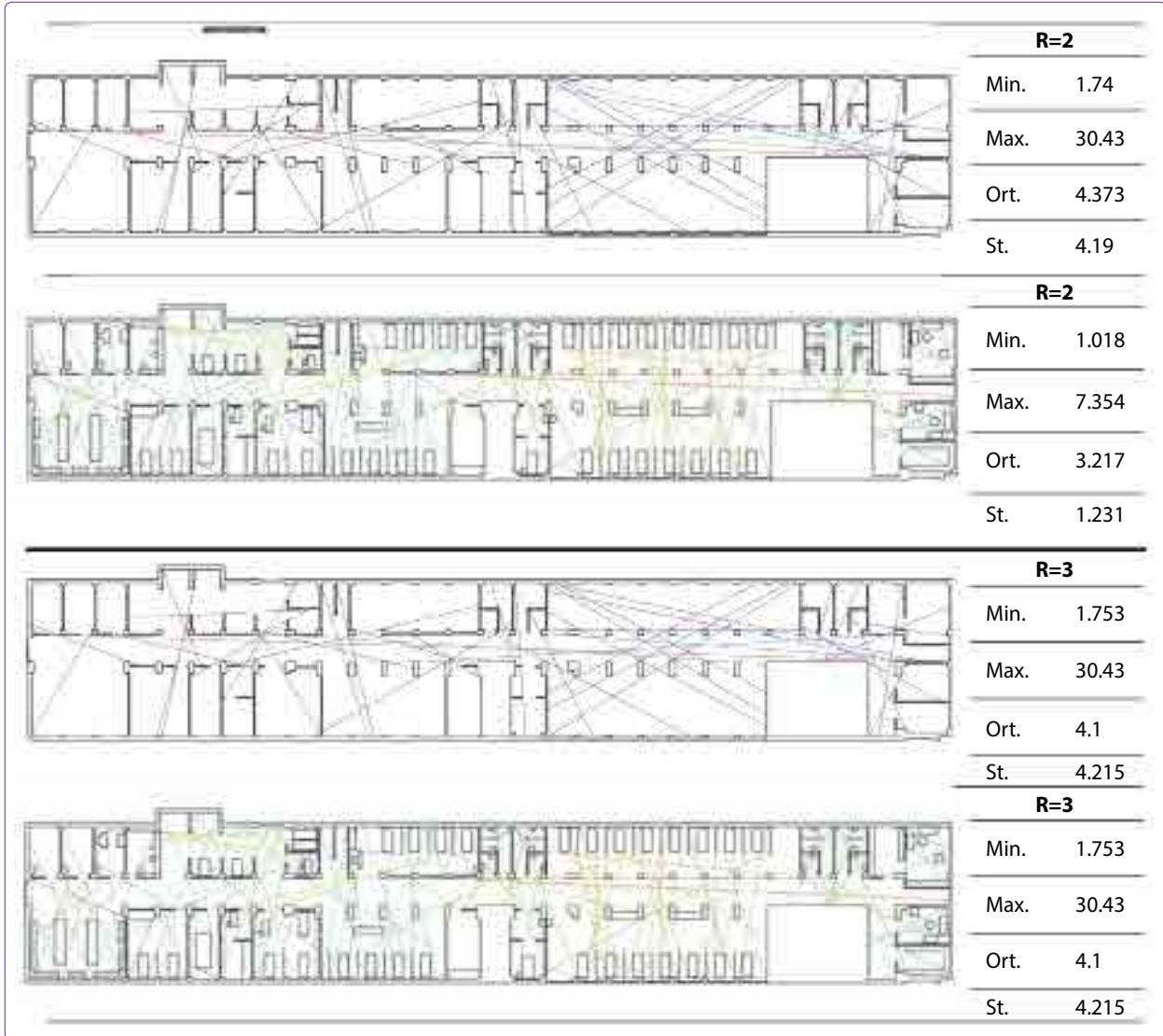
Şekil 8. F.D. Hastanesi donatılı ve donatısız local axial integration analizi (R=2, R=3).
